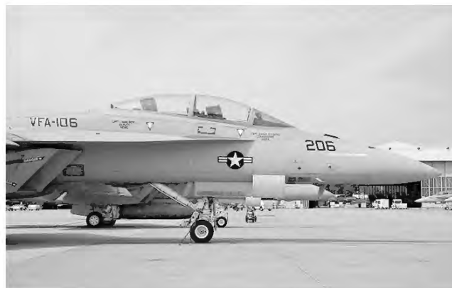
De E en F versie van de Hornet zijn makkelijk herkenbaar aan de rechthoekige luchtinlaten onder de vleugelbasis.
