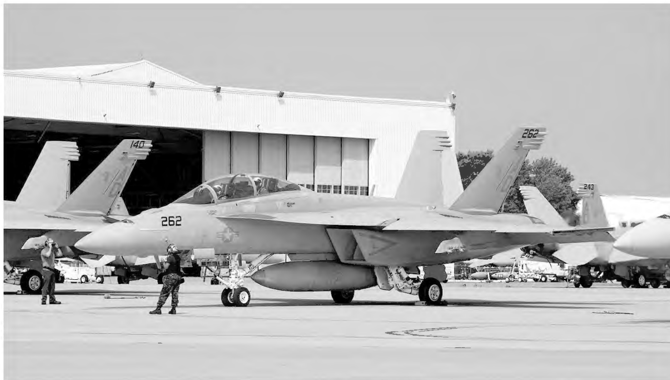
De Super Hornet heeft 11 wapenstations: één aan elke vleugeltip, zes onder de vleugels en drie onder de romp.
